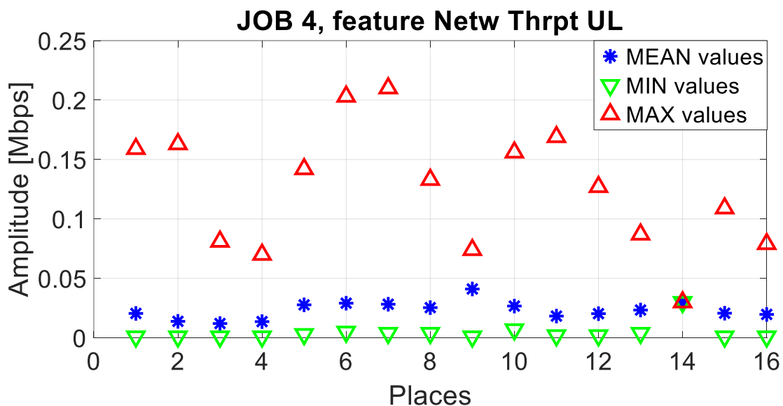
Figura 30: Misura del Throughput UL (valore medio, massimo e minimo) al variare del luogo di misura.
