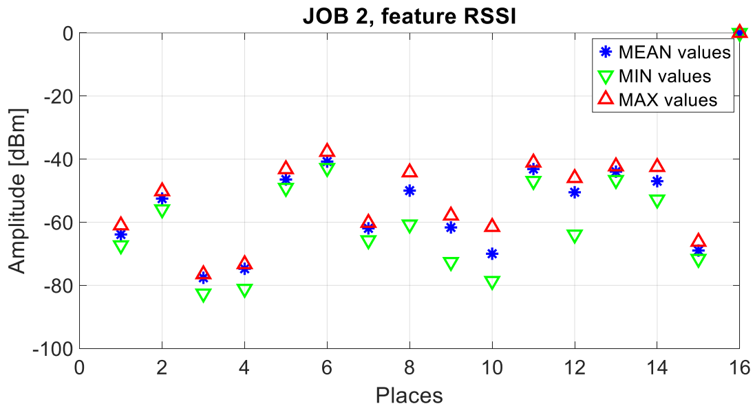
Figura 10: Misura del RSSI (valore medio, massimo e minimo) al variare del luogo di misura.
