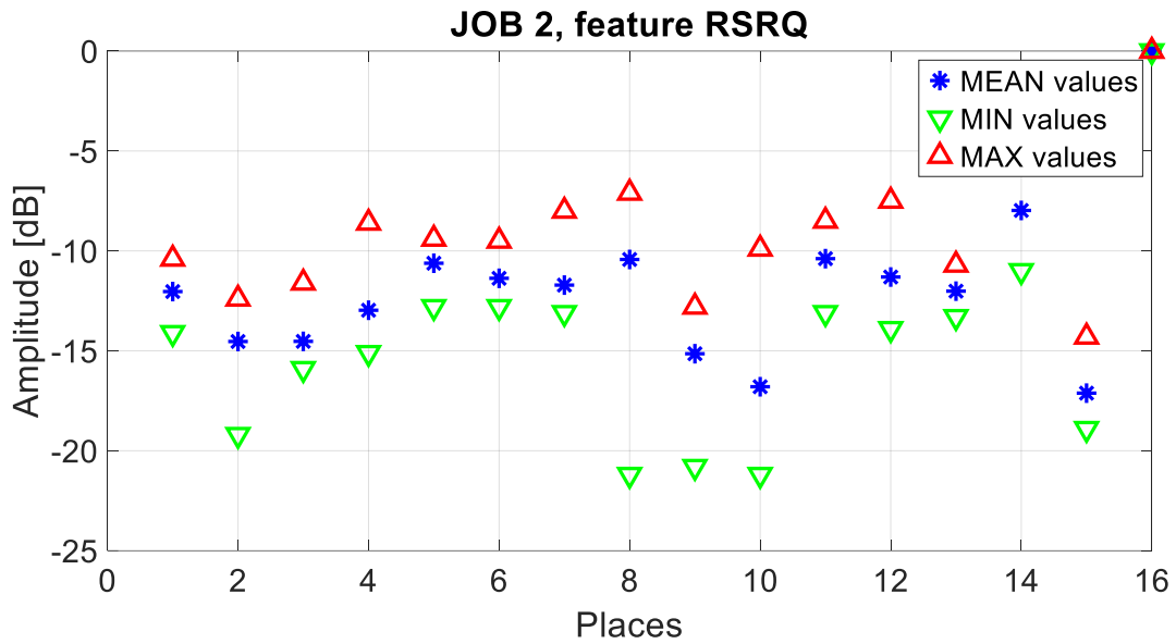
Figura 11: Misura del RSRQ (valore medio, massimo e minimo) al variare del luogo di misura.
