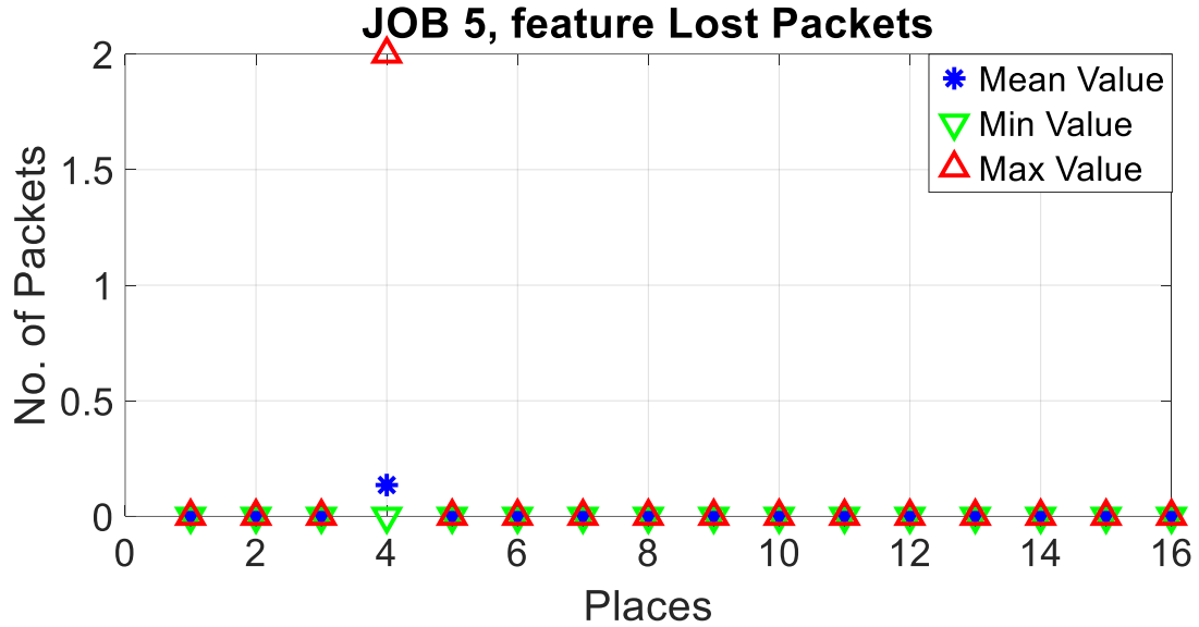
Figura 31: Misura del Lost Packets (valore medio, massimo e minimo) al variare del luogo di misura.
