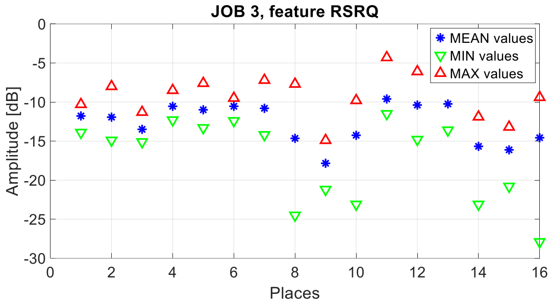
Figura 18: Misura del RSRQ (valore medio, massimo e minimo) al variare del luogo di misura.
