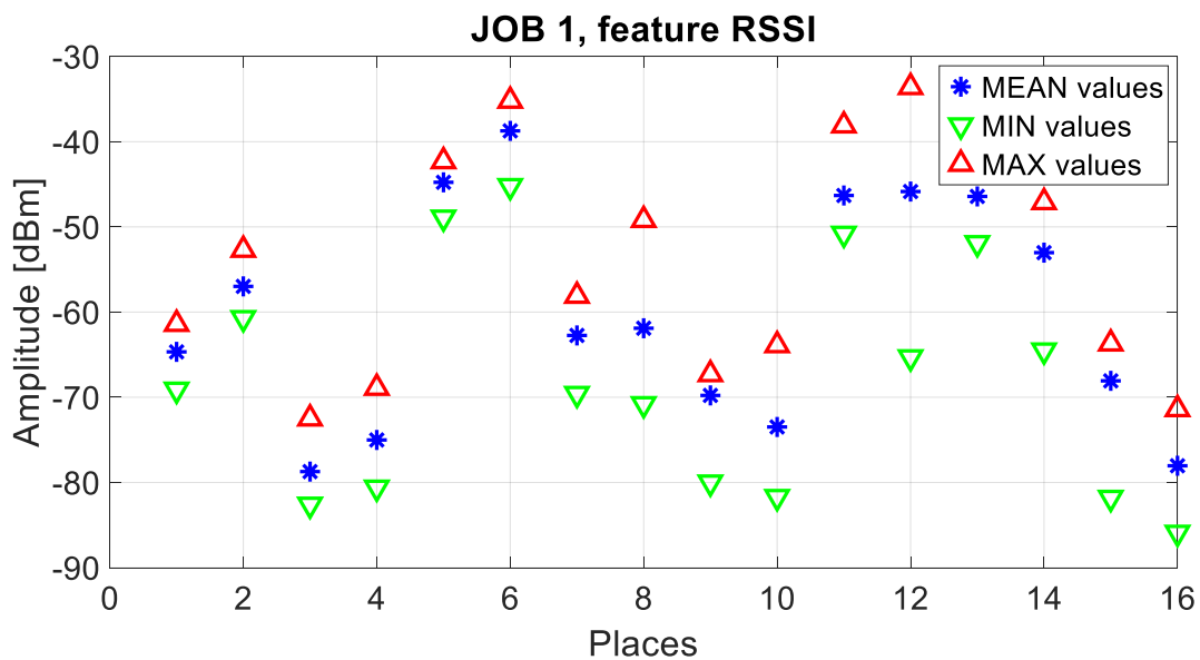
Figura 3: Misura del RSSI (valore medio, massimo e minimo) al variare del luogo di misura.
